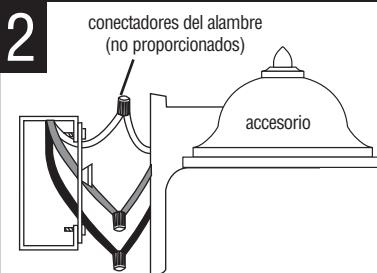
CONECTE LOS ALAMBRES. NOTA: Una el alambre negro del accesorio al alambre negro de la fuente, alambres blancos del accesorio al alambre blanco de la fuente. No los mezcle para arriba. Utilice los conectadores del alambre (no proporcionados). Conecte el wire(s) de tierra del accesorio verde con el alambre de tierra de la caja del enchufe.
