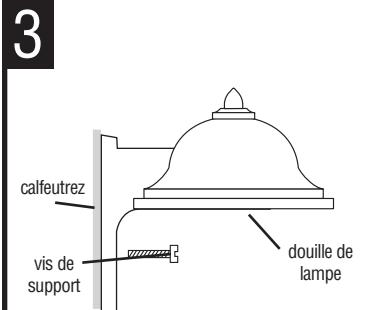
POSITION DE L'APPAREIL sur la boîte de sortie et fixer en place avec la vis de fixation (fournie).
