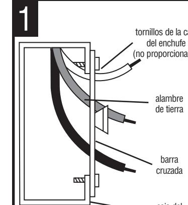
UNA la barra cruzada a la caja del enchufe con los tornillos de la caja del enchufe (no proporcionados).
