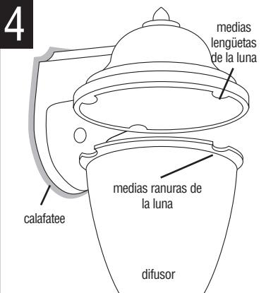
NOTA: El dispositivo debe sellarse con un sellador acrílico donde la base de la luminaria cumple con la superficie de montaje. Esto proporciona un sellado estanco al agua cuando el accesorio está instalado.
