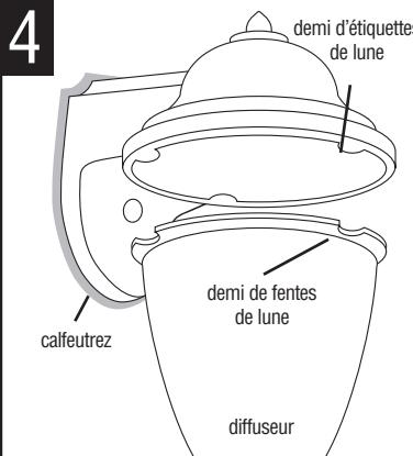
Attachez le diffuseur en alignant demi de lune formée coupée sur le diffuseur avec demi d'étiquette de lune sur le montage et en tournant l'until dans le sens des aiguilles d'une montre de diffuseur contre- que c'est main fermement.
