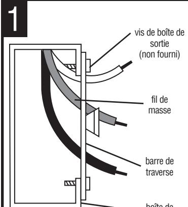
ATTACHEZ la barre de traverse dans la boîte de sortie avec des vis de boîte de sortie (non fournies).
