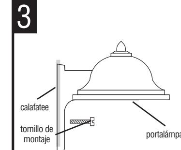
LA POSICIÓN DEL ARTEFACTO en la caja de distribución y asegurar en su lugar con el tornillo de montaje (incluidos).
